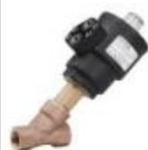
Com acionamento rápido, pode ser utilizada nos dois sentidos do fluxo, fechando a favor do fluxo, em condições em que é necessário o rápido fechamento da válvula, ou contra o fluxo, indicado para inibir golpes de aríete na tubulação, pois dessa forma o acionamento da válvula vai desacelerando a velocidade do fluxo.
